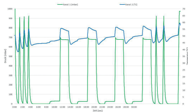
Abb. 4: Temperatur und Druckverlauf in einem H 2 O 2 Zyklus.
