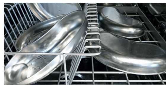
Abb.3 Falsche Beladung/umgekippte Nierenschalen.
