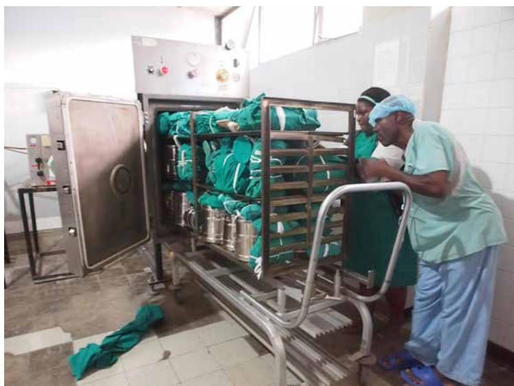
Abb. 5: Beladen eines der beiden auf dem Amsco-Medallion basierenden Autoklaven im Bugando Medical Centre, Tansania (29.11.2019).
